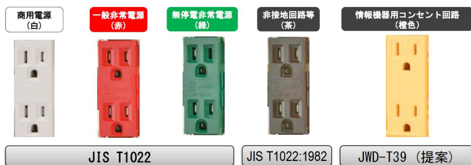
図 9.1.2.2 コンセントの回路表示例 (色別表示)
